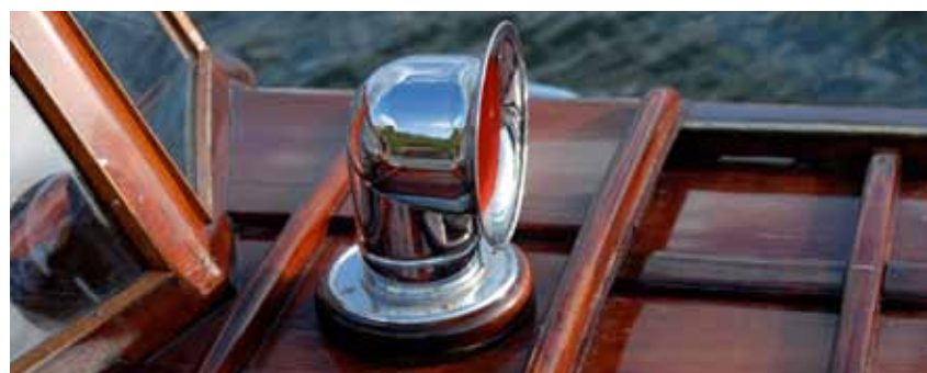
Den stora ventilatorn sitter på den ena av Rakets två skjutluckor, som skjuts på varandra för att blotta det stora motorrummet under fördäck.
